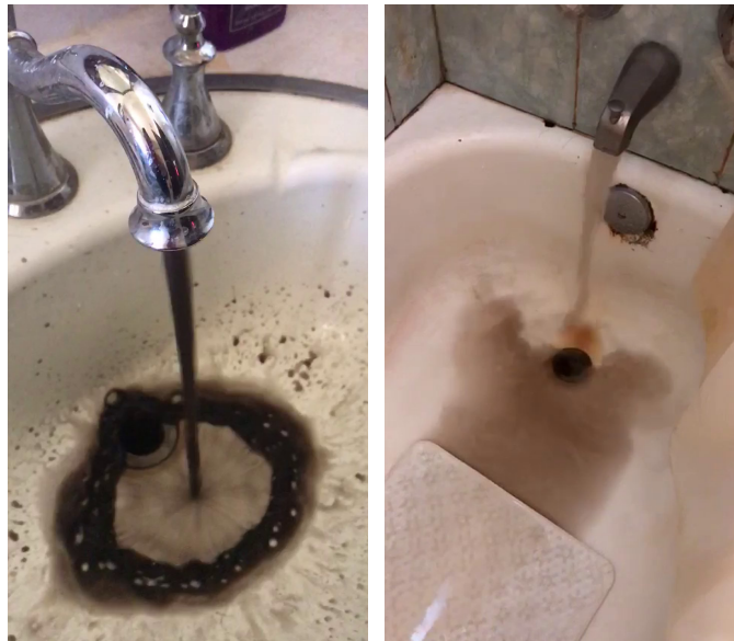
Agua con alta concentración de sedimentos está saliendo de grifos en la ciudad de San Joaquín. A medida que el cambio climático nos empuja hacia sequías y a una mayor extracción de agua, los sedimentos y otros contaminantes se introducen en las tomas de pozos.
